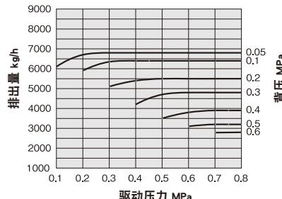
\* 上述流量表示从产品底部至 1000mm 的流入高度 (P2) 的冷凝水量。
